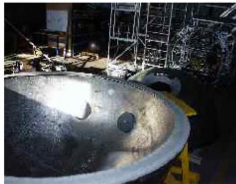
*La sphère part alors en avion vers Washington. Sur les bords du Potomac, l'U.S. Navy possède le seul caisson d'essai capable, à l'époque, de recevoir, une telle sphère et de l'amener à une pression extérieure de 700 bars, l'équivalent de 6 700 mètres d'eau de mer. L'essai en caisson permet de vérifier que la déformation de la coque est bien conforme au calcul.*
